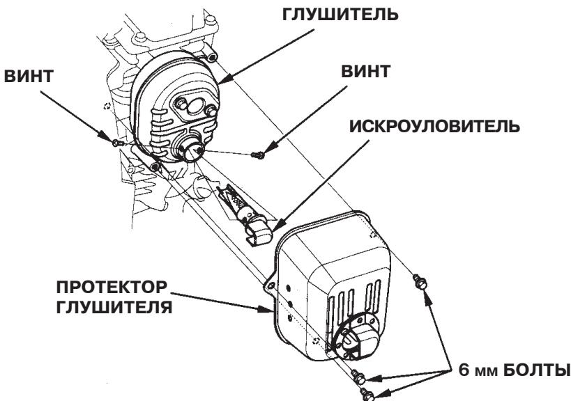
3. С помощью щетки удалите отложения сажи с сетчатого фильтра искроуловителя.
