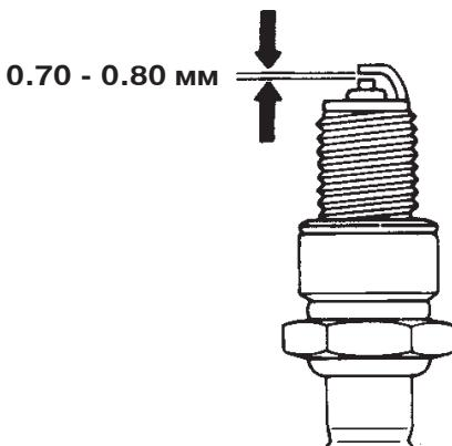
4. Проверьте, чтобы шайба свечи был в хорошем состоянии и ввинтите свечу рукой так, чтобы избежать перекоса резьбы.
