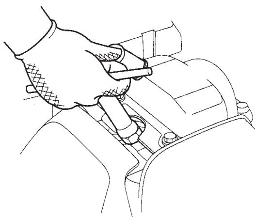
2. Осмотрите свечу. Выбросите свечу, если она выглядит изношенной или если изоляция треснула или крошится. В случае, если свечу еще можно использовать, почистите ее щеткой.
